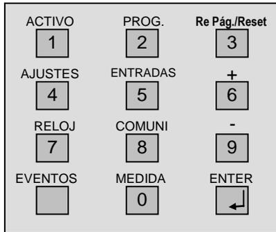
**Fig.1 Teclado de membrana**
